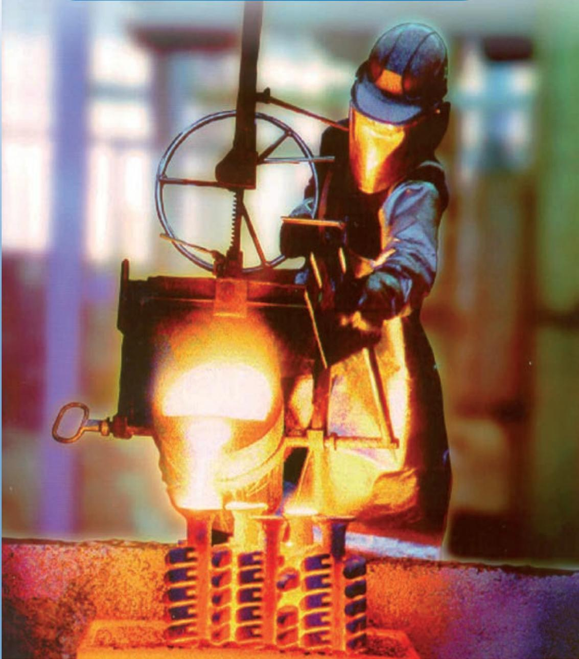
**Die Fertigung von Feingussteilen**
